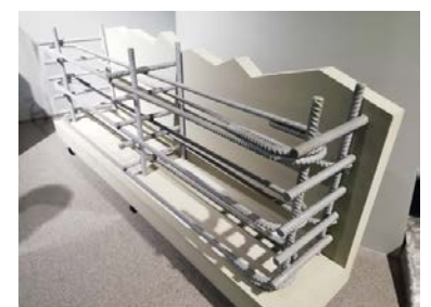
Okl 3 suojakuoren rakenne
